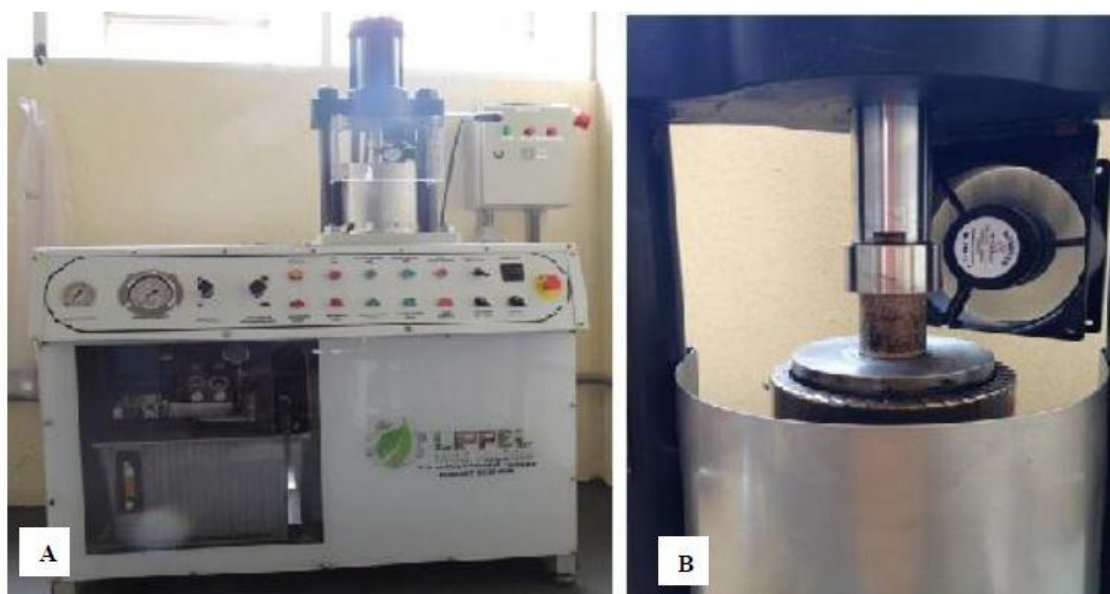
Figura 3 - (A) Briquetadeira laboratorial, (B)resfriamento com ventilação forçada.
